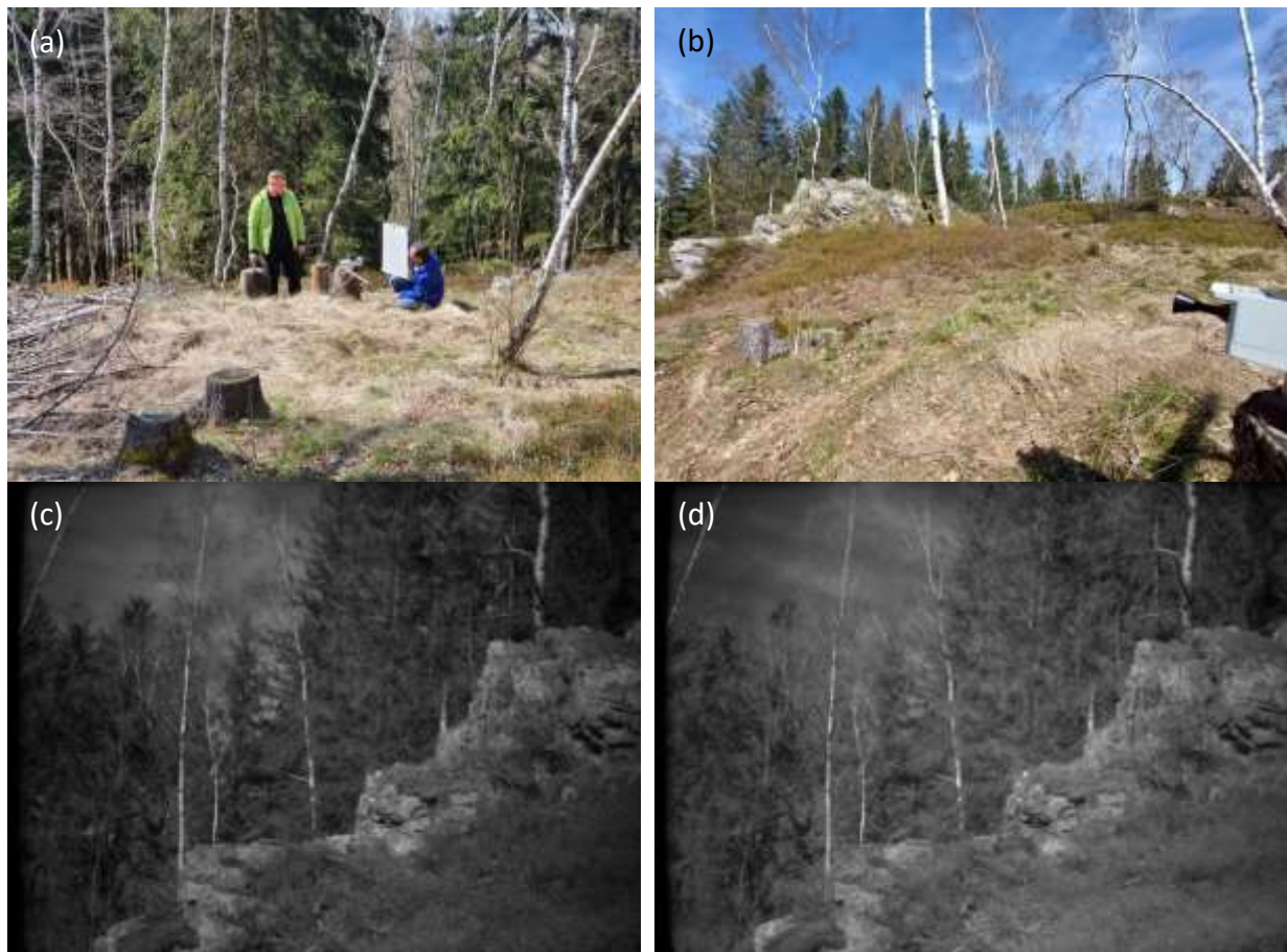
Abb. 1: (a) Kalibrierung der Hyperspektralkamera und (b) Bodenmessungen (mit Beispielbildern bei (c) 560 und (d) 700 nm)
