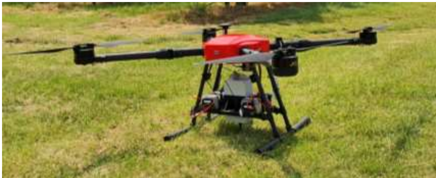
Abb. 3: Hyperspektrales, bildgebendes Messsystem an der Drohne
